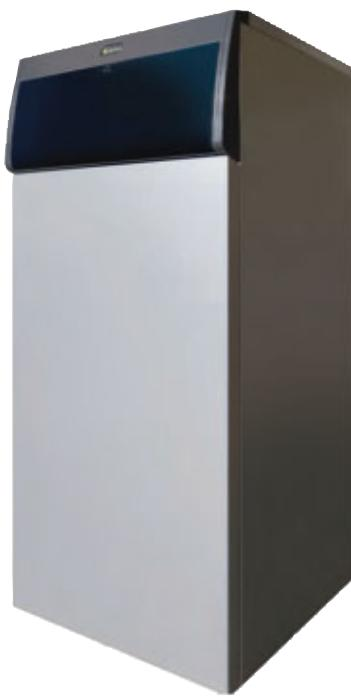
Напольный чугунный газовый двухконтурный котёл FABULA E с открытой камерой сгорания и встроенным бойлером-аккумулятором ГВС предназначен для отопления и горячего водоснабжения помещений различного назначения. Выпускается пять типоразмеров номинальной теплопроизводительностью от 27 до 43 кВт.
